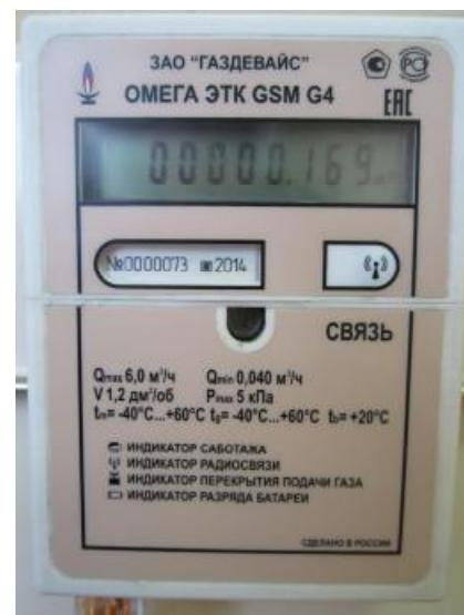
Рисунок 2 – Табличка счетчика газа
