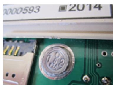
Рисунок 3 – Место пломбирования
