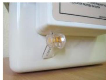
Рисунок 4 – Пломбирование крышки батарейного отсека
