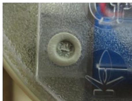
Рисунок 4 – Место пломбирования ОТК
