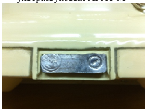
Рисунок 3 – Место пломбирования и нанесения знака поверки
