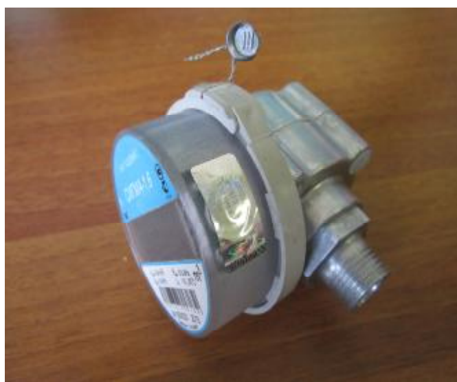
Рисунок 3 - Место пломбирования гнезда для подключения к внешним системам сбора данных.
