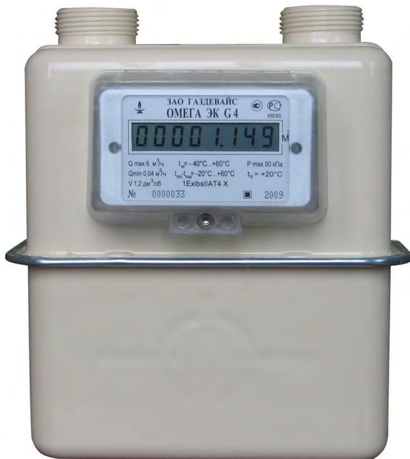
1. Счетчики газа объемные диафрагменные с автоматической температурной компенсацией ОМЕГА ЭК (G1,6; G2,5; G4), ОМЕГА ЭК (G1,6; G2,5;G4) К правостороннего и левостороннего исполнений предназначены для измерений прошедшего через них объема газа (природного газа по ГОСТ 5542, сжиженного газа по ГОСТ 20448 и других не агрессивных газов) в газопроводе низкого давления с приведением измеряемого объема газа к нормальным условиям по температуре (+20 °С) по ГОСТ 2939.
