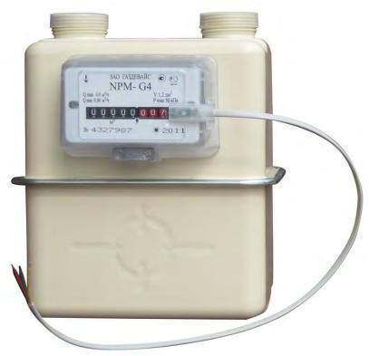
Бытовой счетчик газа мембранного типа NPM (НПМ) типоразмеров G1,6; G2,5; G4 используется для учета расхода газа (сжиженный, природный, крекинг-газ, углеводородный газовый состав и других неагрессивных газов) в ЖКХ и быту. По потоку газа разделяют модели правосторонние (подача справа-налево) и, соответственно, левосторонние.
